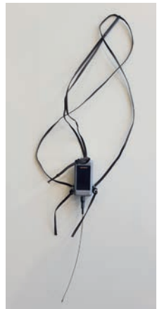
GPS-Datenlogger eines Großen Brachvogels
